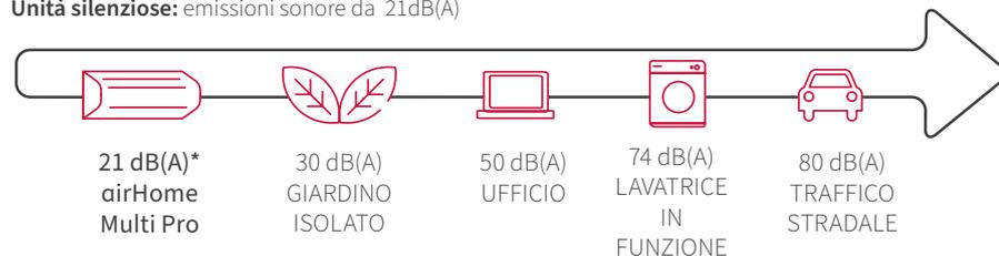
\* 21 dB(A) di pressione sonora misurata alla bassa velocità di funzionamento, ad 1 m dall'unità in campo libero
